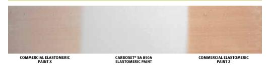
CARBOSET® SA 850A POLYMER SHOWS SUPERIOR DIRT RESISTANCE COMPARED WITH TWO COMPETITIVE ELASTOMERIC COATINGS.
